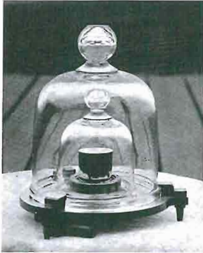
الشكل 7 النموذج الأول الدولي للكيلوجرام. هو البعير لكتلة الكيلو جرام ويتكون من خليط من البلاتينيوم والأيريديوم. محفوظ في فراغ كي لا يفقد كتلته. ويعمل العلماء على إعادة تعريف الكيلوجرام البعير باستخدام كرة تامة الاستدارة مصنوعة من السيليكون. صِف ما وجه الأهمية في وجود معايير للقياسات؟
